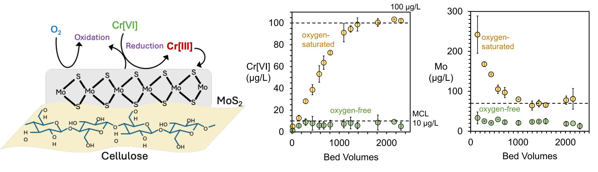
$\equiv \text{MoS}_2 + 6\text{HCrO}_4^- + 6\text{H}_2\text{O} \rightarrow \text{MoO}_4^{2-} + 2\text{SO}_4^{2-} + 6\text{Cr}^{3+} + 180\text{H}^{-1}$  $\equiv \text{MoS}_2 + \frac{7}{2}O_2 + 3H_2O \rightarrow \text{MoO}_4^{2-} + 2SO_4^{2-} + 6H^+$
